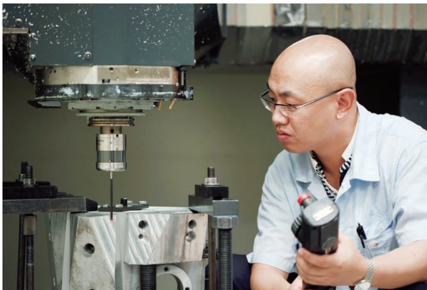
戴天方正在用高精度3D测量探头测量工件的加工精度
